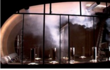
Hava akışı testleri: TROX araştırma ve geliştirme laboratuarında maket kurulum
